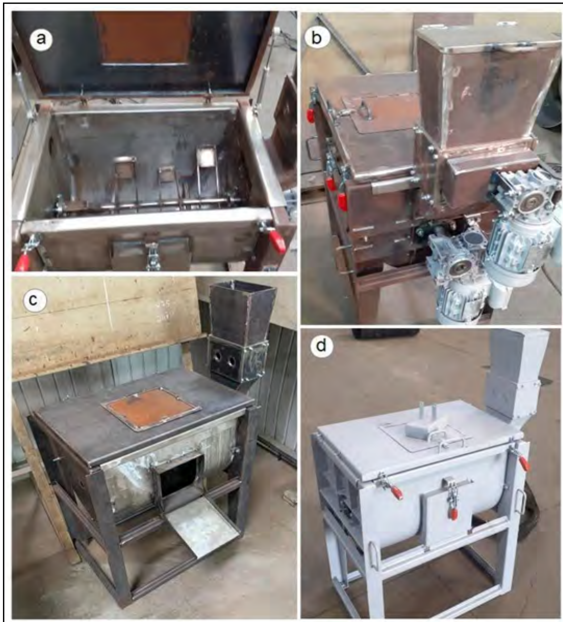
Figura 4: Etapas do processo de fabricação da carcaça do reator.
