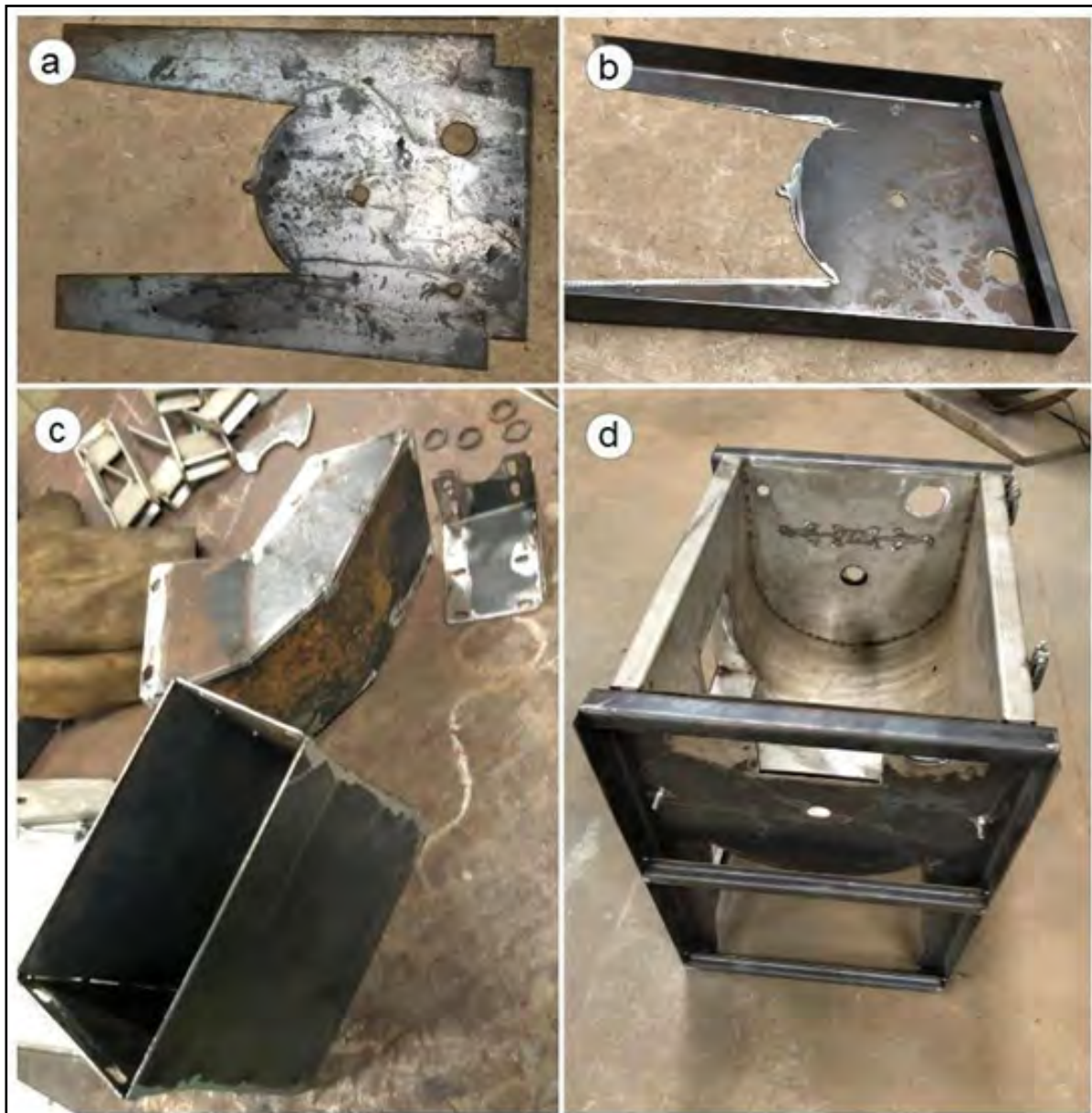
Figura 3: Etapas do processo de fabricação da carcaça do reator.
